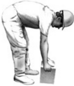
Manera incorrecta de levantar
